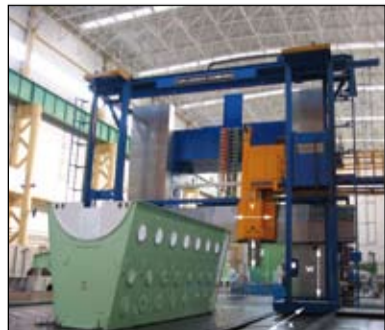
Obrábění bloků motorů pro zaoceánské lodě
