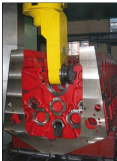
Obrábění vnitřní plochy bloku motoru speciální hlavou
